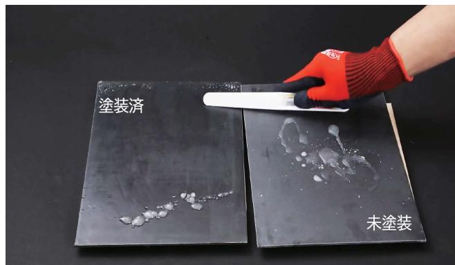
左図の鉄板を凍らせたもの。未塗装の表面はコテで削れないほどしっかりと凍って下地とくっついていますが、塗装済のほうはすぐに溶け出し、なぞると氷の粒が簡単に落とせます。
